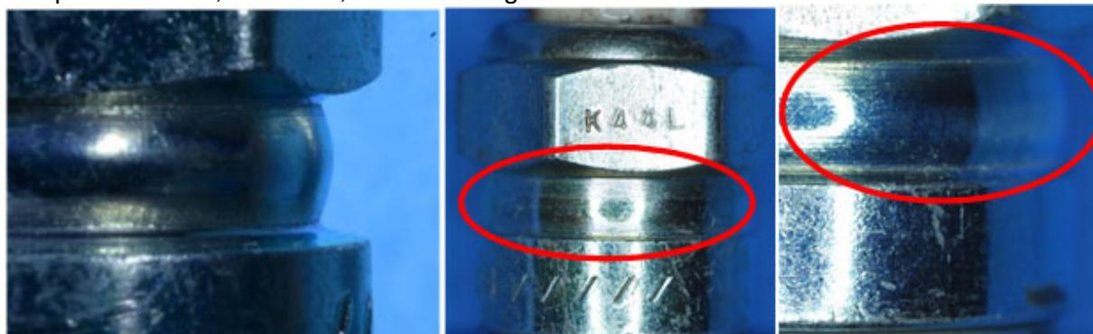
Imagen izquierda: Producto original sin marca de mecanizado. Derecha: marca de mecanizado por corte en la superficie del casquillo metálico en la parte de ranura en C (falsificada).
