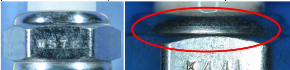
Imagen izquierda: Producto original. Derecha: Producto falsificado con marcas de mecanizado en la parte de engarce.
