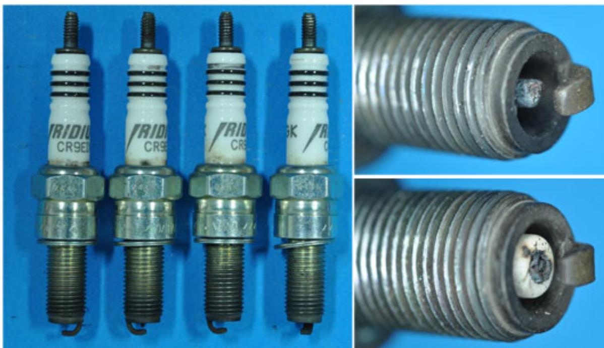
Ejemplos de electrodos centrales fundidos en bujías de encendido CR9EIX falsas.
