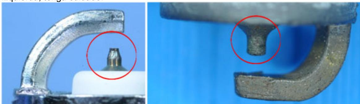
Imagen izquierda: Electrodo de un producto original. Derecha: Electrodo de un producto falso.
