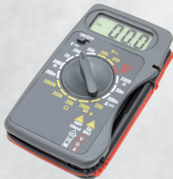
Unverzichtbarer Helfer beim Glühkerzen-Check: ein Multimeter, das geringe Prüfspannungen anzeigen kann.
