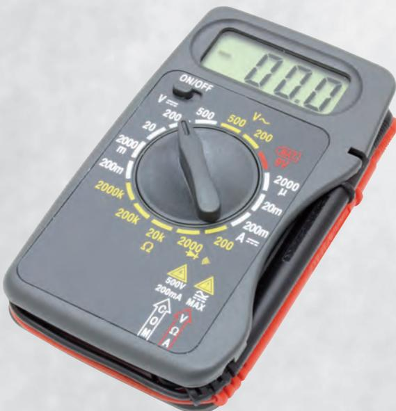
Una ayuda indispensable para comprobar calentadores: un multímetro que pueda mostrar tensiones bajas.
