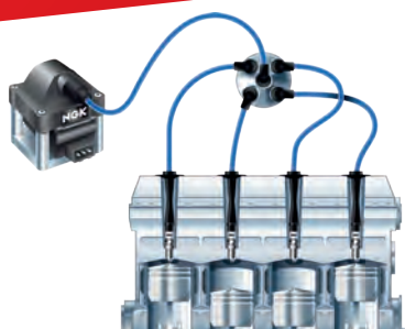
DISTRIBUCIÓN GIRATORIA DE ALTA TENSIÓN
