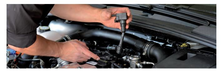
Igual que muchos otros componentes, la bobina de encendido también está sujeta a un cierto grado de desgaste. Su vida útil se sitúa generalmente entre los 60.000 y los 80.000 kilómetros, pero existen varios factores que pueden afectar negativamente a su durabilidad.
