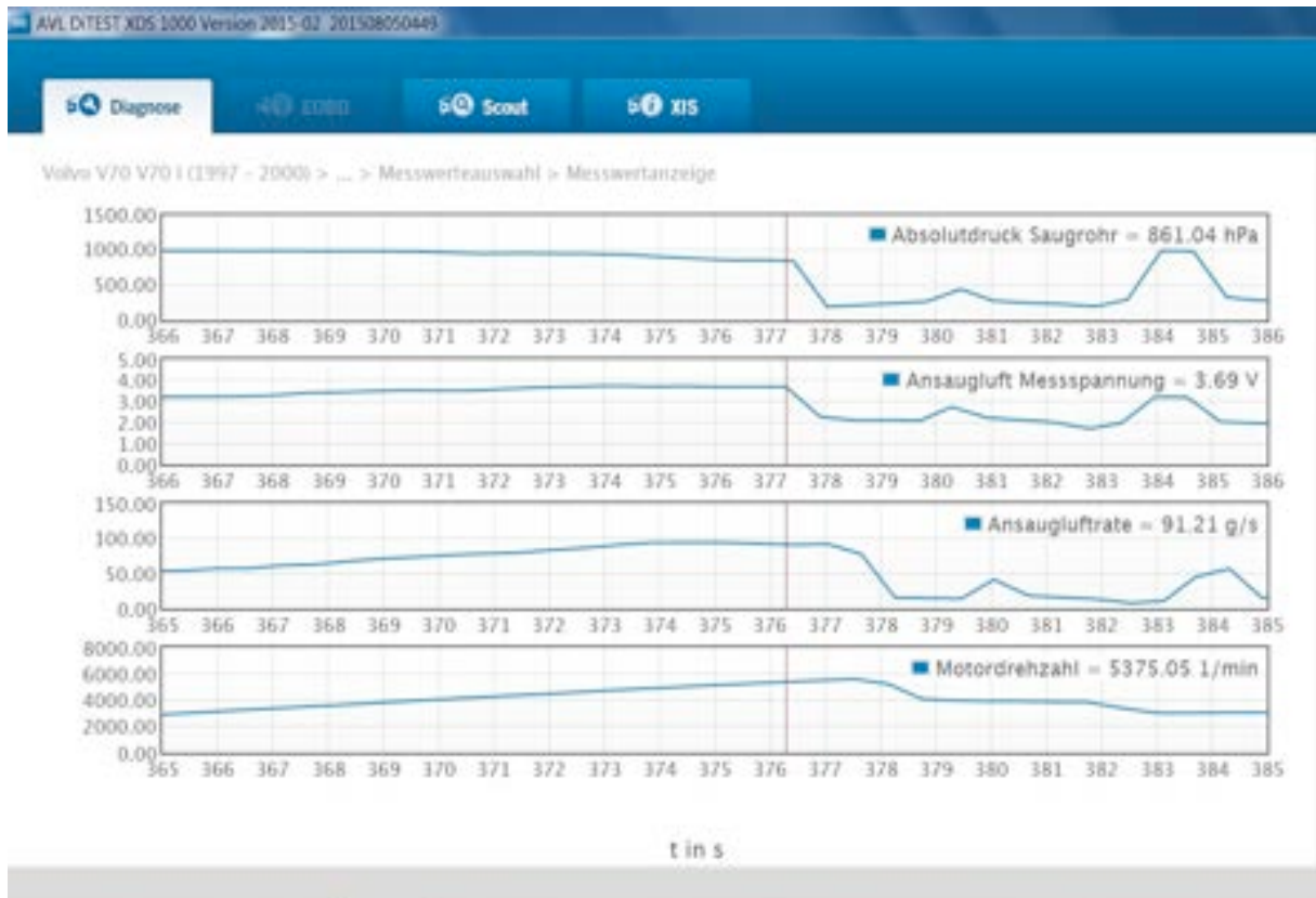
Рисунок 10: Двигун на Рис. 9 після невдалої спроби очищення витратоміра повітря. Незважаючи на збільшення значення кількості повітря від 44 г/сек до 91 г/сек, стандартне значення 125 г/сек не досягається, про що свідчить низька напруга сигналу 3,7 В.
