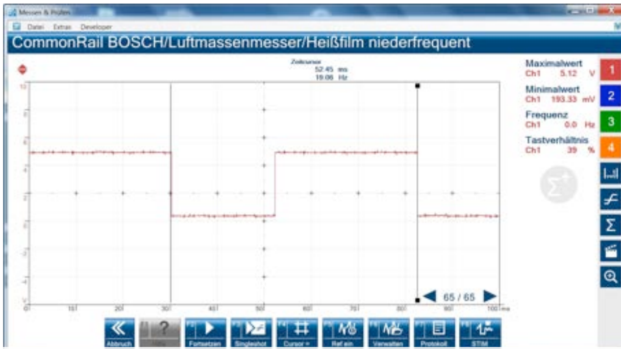
Рисунок 7: Для автомобіля на Рис. 5 температура вхідного повітря теж відображається у вигляді прямокутного сигналу. Частота становить лише 15 Гц. Режим роботи міняється в залежності від температури.
