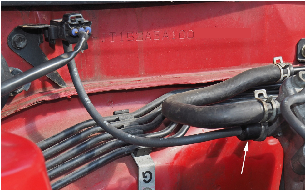
Resim 1: Benzinli bir motorun, emme manifoldu basınç sensörü. Ok işareti, pnömatis gaz kelebeğini gösterir
