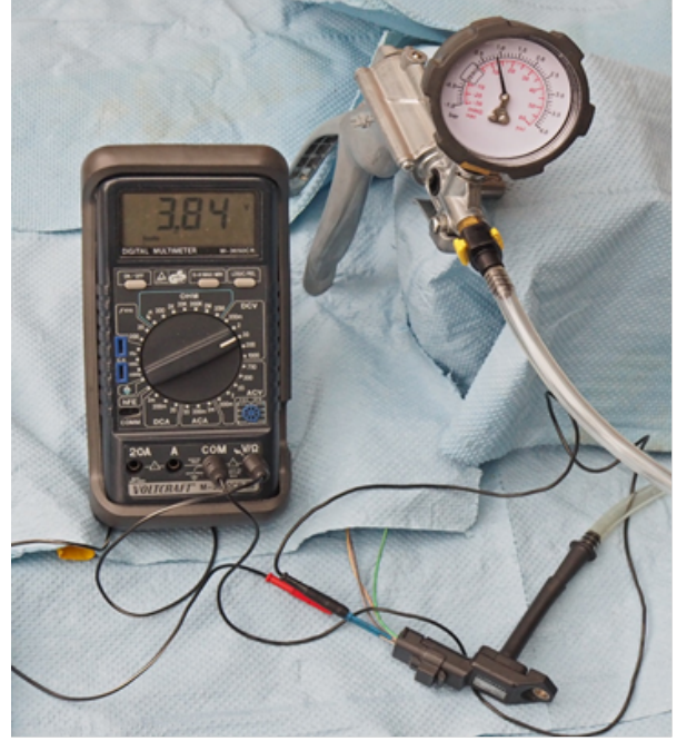
Resim 3: Bir turbo motorun 0,9 bar'lık bir yüksek basınçta (mutlak 1,9 bar) takviye basınç sensöründe sinyal voltajı ölçümü. Sinyal voltajı 3,84 volt'tur
