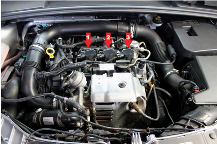
Resim 1: Ford Focus 1.0 EcoBoost motor bölmesi. Ateşleme bobinlerinin yeri
