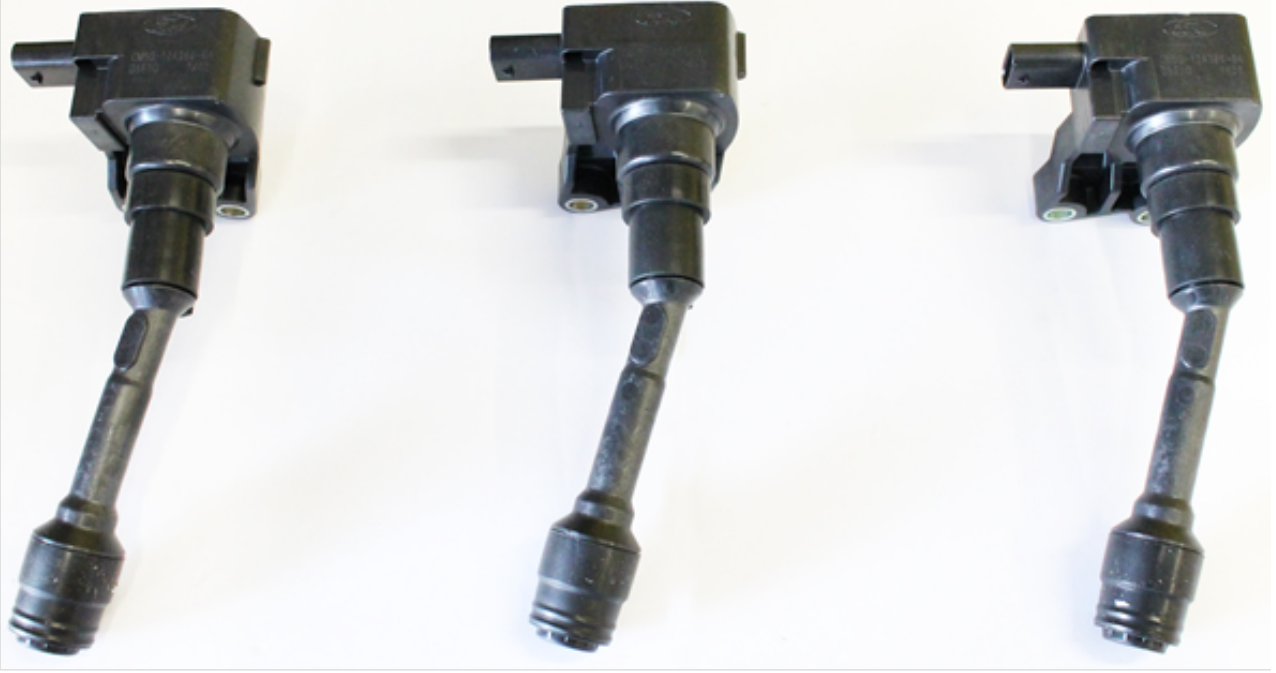
Resim 2: Ateşleme bobinlerinin ayrıntısı
