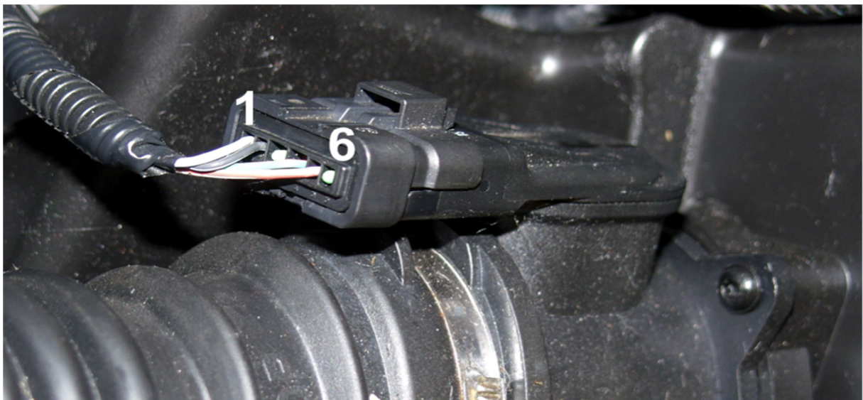
Şekil 3: Bir hava kütlesinin pim atama örneği. Pim1: Emilen hava sıcaklık sensörünün sinyali Pim 2: Şasi Pimi 4: Güç kaynağı, +12 V Pim 5: Hava akış sinyali
