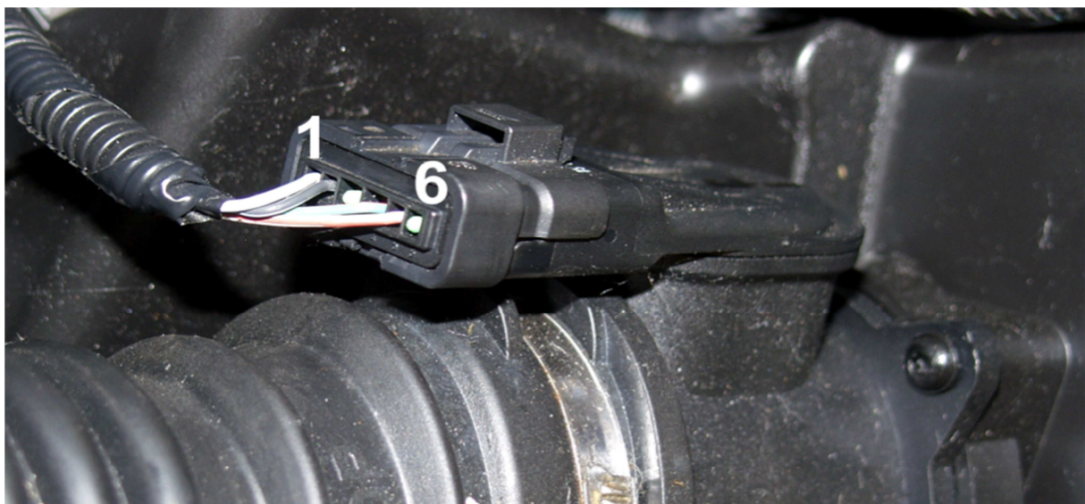
Figur 3: Exempel på en luftmängdmätarens stifttilldelning. Stift 1: Signal från intagsluftstemperaturgivaren. Stift 2: Jordning. Stift 4: Strömförsörjning, +12 V.
