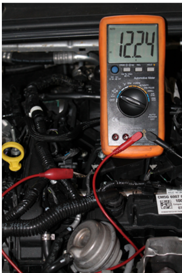
Изображение 5: 12.24 В Подача питания на катушку зажигания
