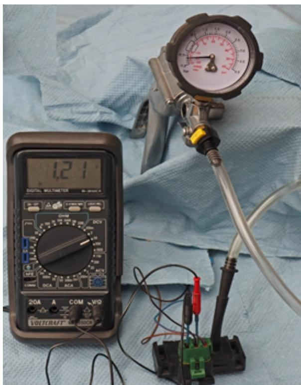
*Imagem 2: Medir o sinal de tensão no sensor de pressão do coletor de admissão de um motor a gasolina sem sobrealimentação. Com um vácuo de -0,6 bar ( 0,4 bar absoluto) a tensão do sinal é 1,21 Volt*
