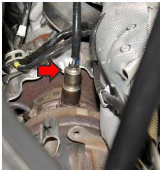
*Posicionamento da sonda lambda*
