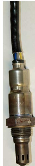
*Identificação de uma sonda lambda de banda*
