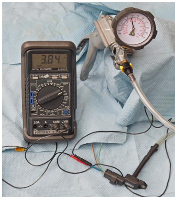
Ilustracja 3: Pomiar napięcia sygnału przy czujniku ciśnienia doładowania silnika z turbodoładowaniem przy nadciśnieniu 0,9 bara (wartość bezwzględna 1,9 bara). Napięcie sygnału wynosi 3,84 V
