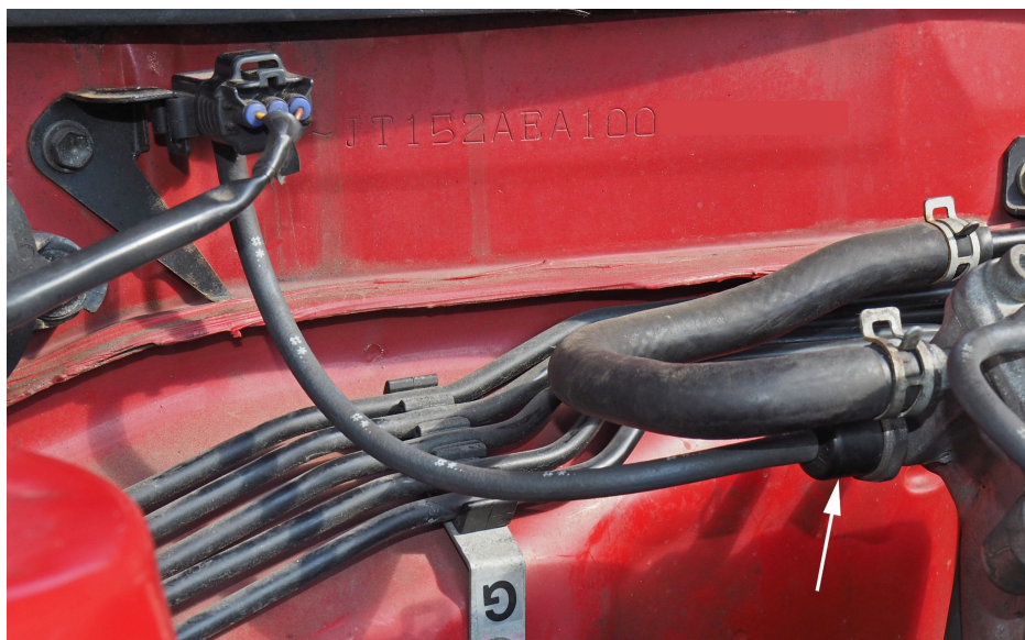
Ilustracja 1: Czujnik ciśnienia kolektora ssącego w silniku benzynowym. Strzałka wskazuje przepustnicę pneumatyczną
