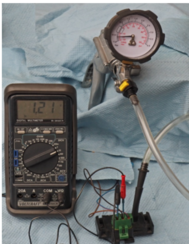
Ilustracja 2: Pomiar napięcia sygnału przy czujniku ciśnienia kolektora ssącego silnika benzynowego bez turbodoładowania. Przy podciśnieniu -0,6 bara (wartość bezwzględna 0,4 bara) napięcie sygnału wynosi 1,21 V
