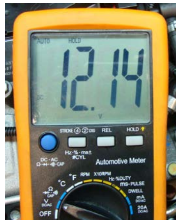
Zasilanie obwodu podgrzewacza
