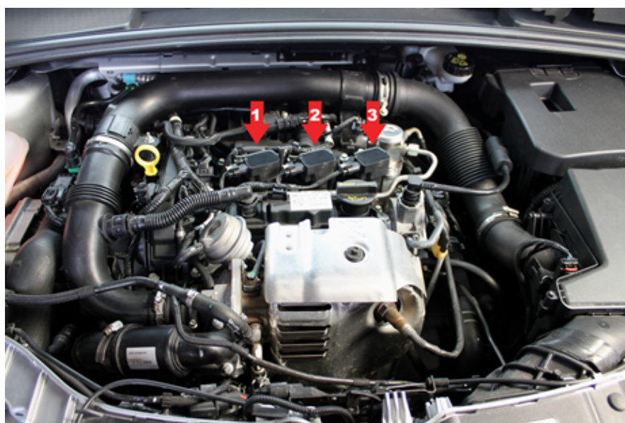
Ilustracja 1: Ford Focus – komora silnika 1.0 EcoBoost Lokalizacja cewek zapłonowych
