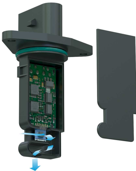
Rysunek 1: Układ przepływomierza masowego powietrza. Źródło: NTK
