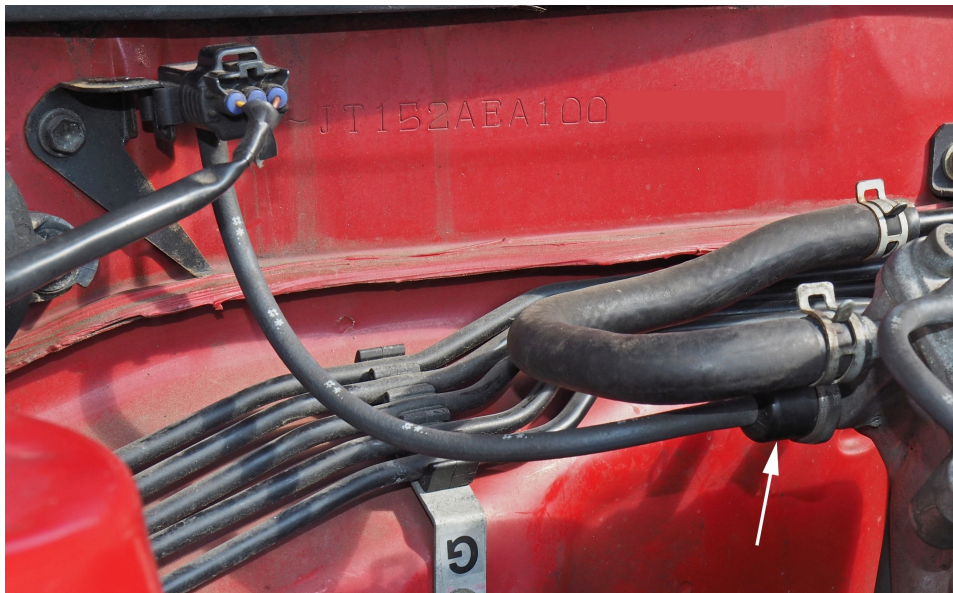
Afbeelding 1: De inlaatspruitstuk-druksensor van een benzinemotor. De pijl geeft de pneumatische gasklep aan
