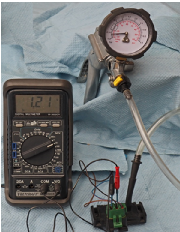
Afbeelding 2: Het meten van de signaalspanning bij een inlaatspruitstuk-druksensor van een benzinemotor zonder turbo. Bij een vacuüm van -0,6 bar (absoluut 0,4 bar) is de signaalspanning 1,21 volt
