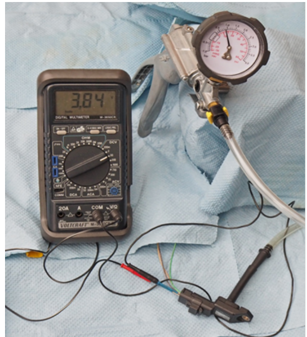
Afbeelding 3: Meting van de signaalspanning bij de laaddruksensor van een turbomotor bij een overdruk van 0,9 bar (absoluut 1,9 bar). De signaalspanning is 3,84 volt
