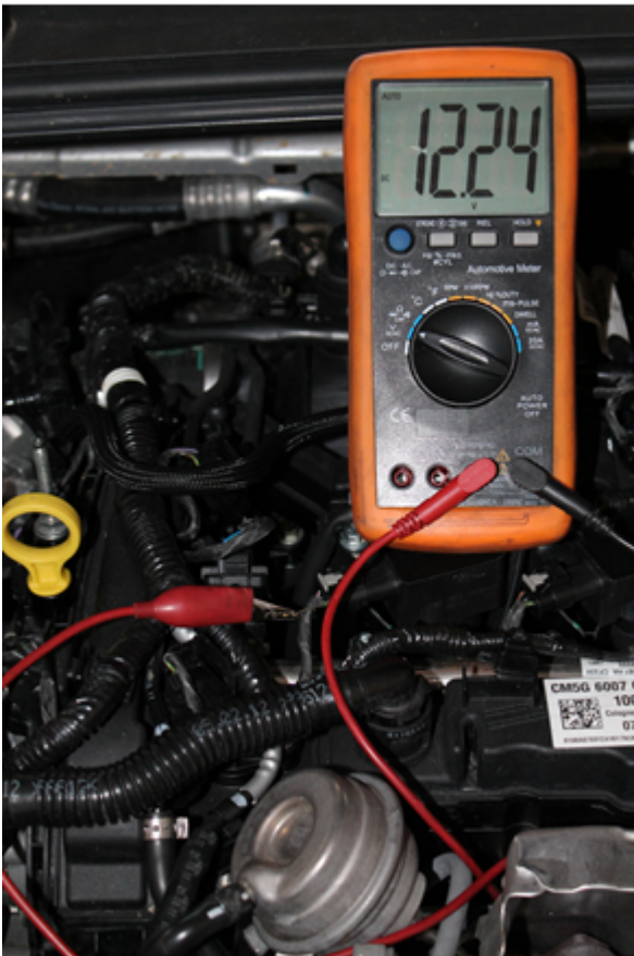
Afbeelding 5: 12.24V Bobine Stroomtoevoer
