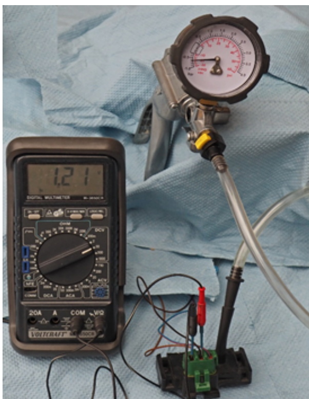
Immagine 2: Misurare la tensione del segnale in un sensore di pressione del collettore di aspirazione di un motore a benzina senza turbocompressione. In un vuoto di -0,6 bar (assoluta di 0,4 bar) la tensione del segnale è 1,21 Volt
