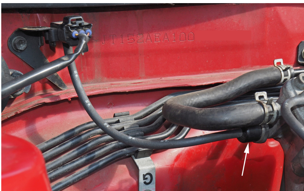
Immagine 1: Sensore di pressione del collettore di aspirazione di un motore a benzina. La freccia indica la valvola a farfalla pneumatica
