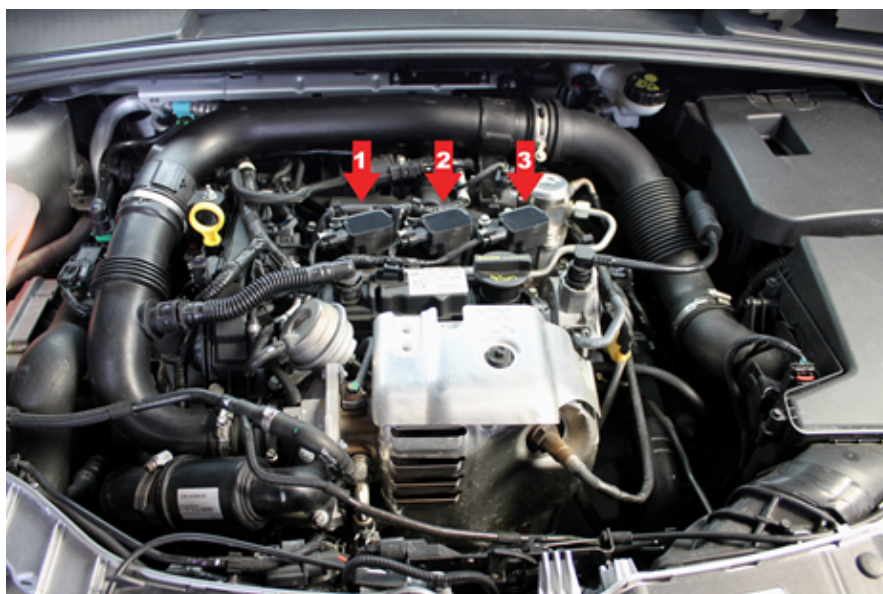
1. kép Ford Focus 1.0 EcoBoost motortér. A gyújtótekercecsek elhelyezkedése
