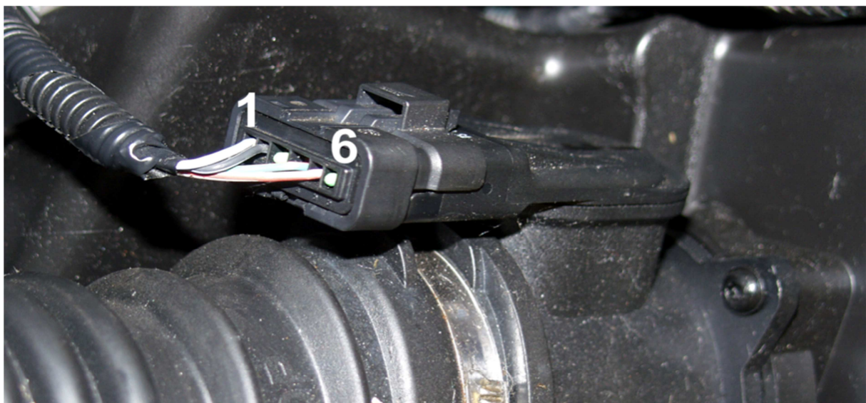
3. ábra: Példa egy légtömegmérő érzékelőláb hozzárendelésére. Érzékelőláb1: A hőmérséklet-érzékelő jel beszívott levegő érzékelőláb 2: Földelő érzékelőláb 4: Tápellátás, +12 V 5. érzékelőtüske: Légáram jel.
