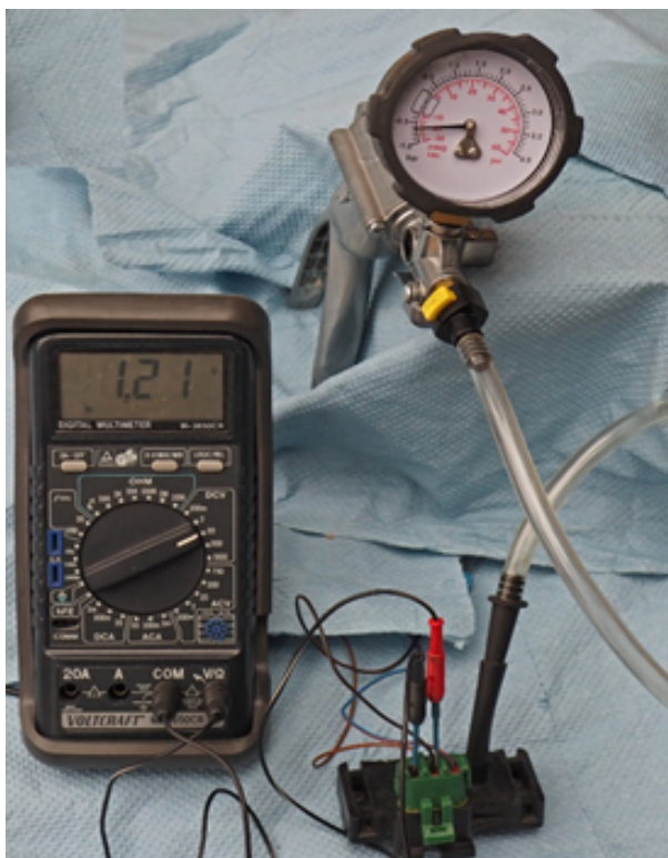
Εικόνα 2: Μέτρηση τάσης σήματος σε αισθητήρα πίεσης πολλαπλής εισαγωγής βενζινοκινητήρα χωρίς υπερπλήρωση. Σε κενό με πίεση -0.6 bar (απόλυτη πίεση 0,4 bar) η τάση σήματος είναι 1,21 Volt
