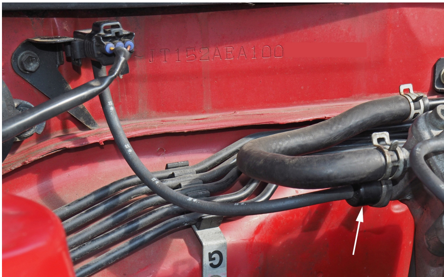
Εικόνα 1: Αισθητήρας πίεσης πολλαπλής εισαγωγής βενζινοκινητήρα. Το βέλος δείχνει προς την πνευματική στραγγαλιστική βαλβίδα
