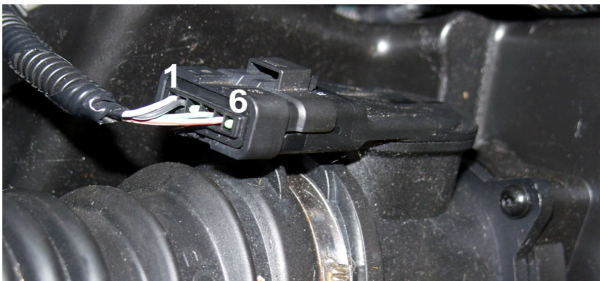
Εικόνα 3: ενδεικτικό Παράδειγμα φίσας ενός μετρητή μάζας αέρα. Ακρ. 1: Σήμα αισθητήρα θερμοκρασίας αέρα εισαγωγής Ακρ. 2: Ακροδέκτης γείωσης Ακρ. 4: Τροφοδοσία, +12 V Ακρ. 5: Σήμα μάζας αέρα.
