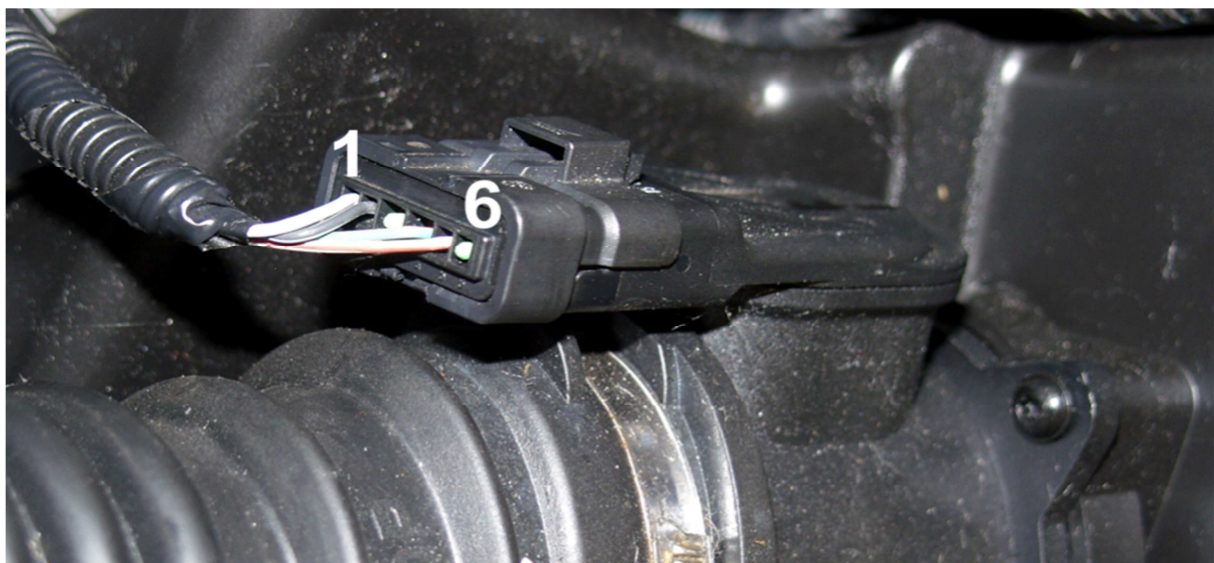
Bild 3: Beispiel für die Pinbelegung eines Luftmassenmessers. Pin 1: Signal des Temperaturfühlers Ansaugluft Pin 2: Masse Pin 4: Spannungsversorgung +12V,
