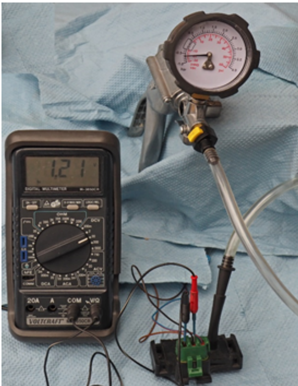
Abbildung 2: Die Messung der Signalspannung an einem Saugrohrdrucksensor eines Ottomotors ohne Aufladung. Bei einem Unterdruck von -0,6 bar (absolut 0,4 bar) beträgt die Signalspannung 1,21 Volt
