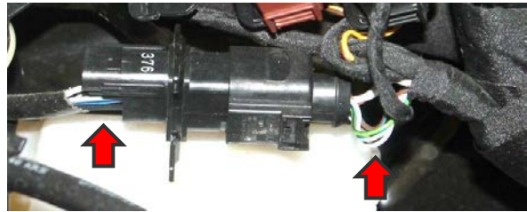
Ansicht des fahr- zeugseitigen Steck- verbinders
